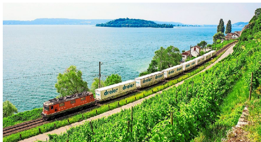
Seit 1988 setzt die Dreier AG auf den kombinierten Verkehr, bei dem Wechselbrücken mit der Bahn transportiert werden. z.Vg
